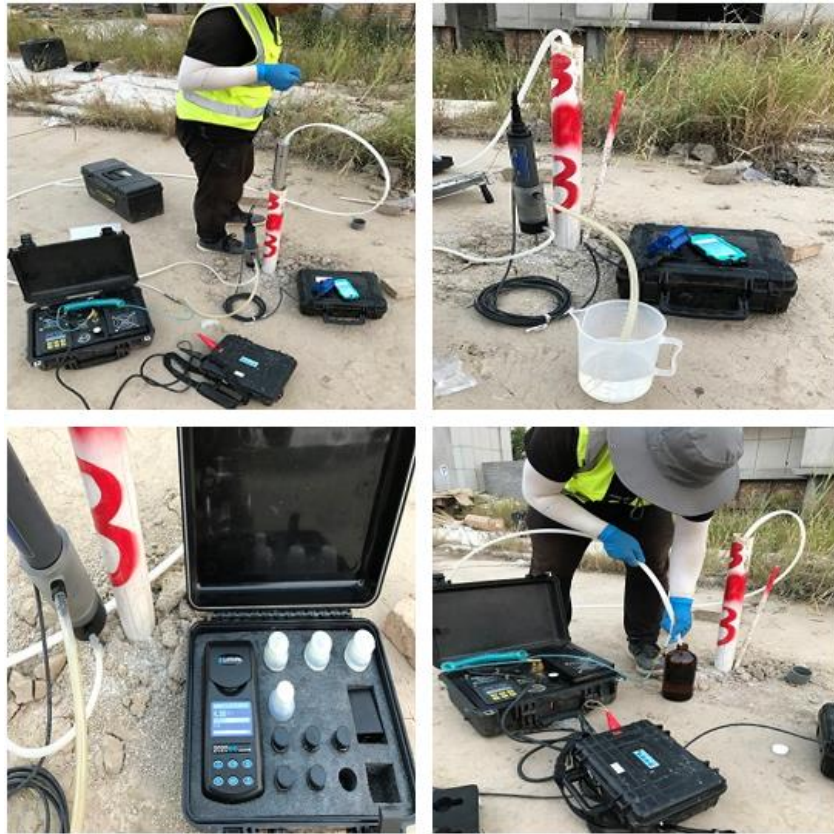
图 6-9 采样前气囊泵洗井
