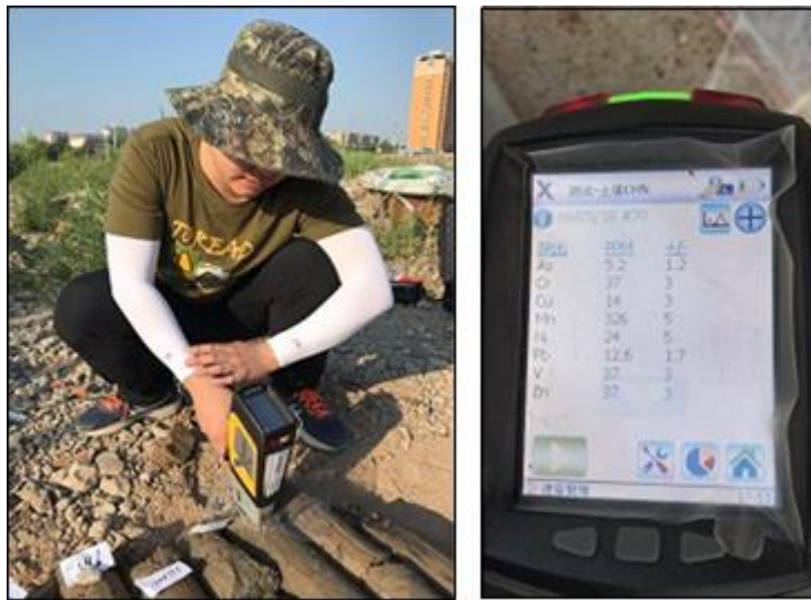
图 7-1 现场 XRF 快速检测
