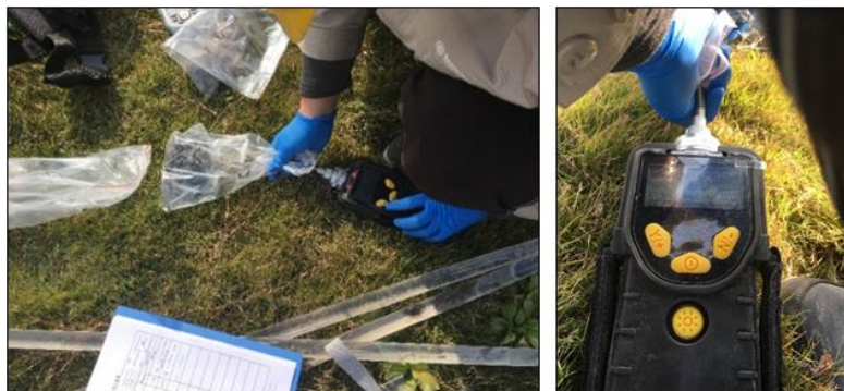
图 7-2 现场 PID 快速检测
